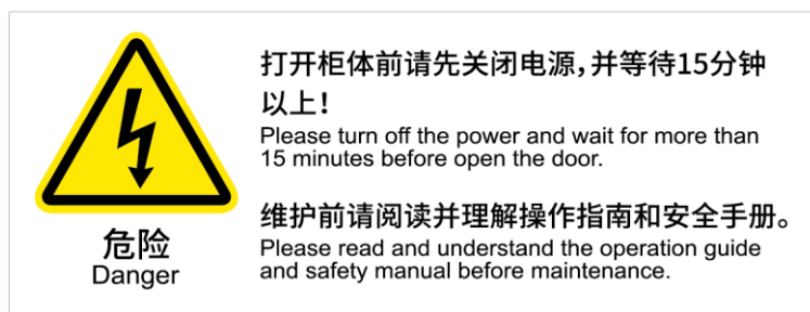
图 1-6 开门断电&维护指示牌
