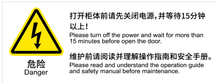
图 1-6 开门断电&amp;维护指示牌
