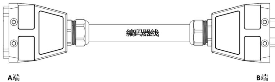
图 3-3 ARC4-165 编码器线示意图
