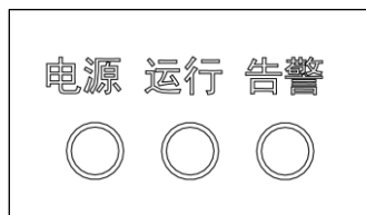
图 2-10 控制柜指示灯
